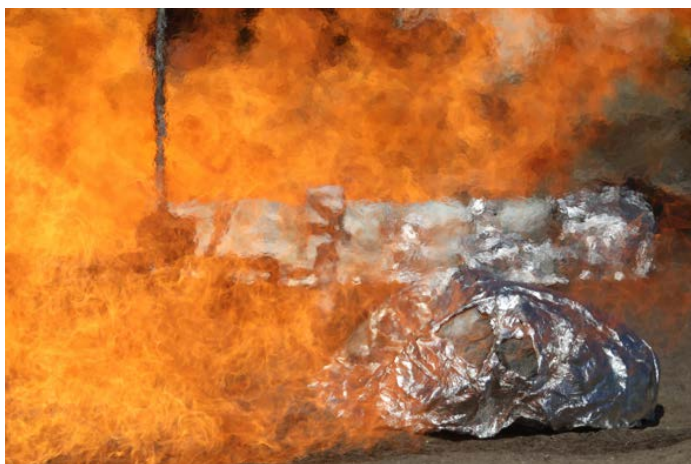
Figura n. 1 – Test di un prototipo di rifugio antincendio (Servizio forestale del Pacifico Sud-occidentale, USDA, 2023).
